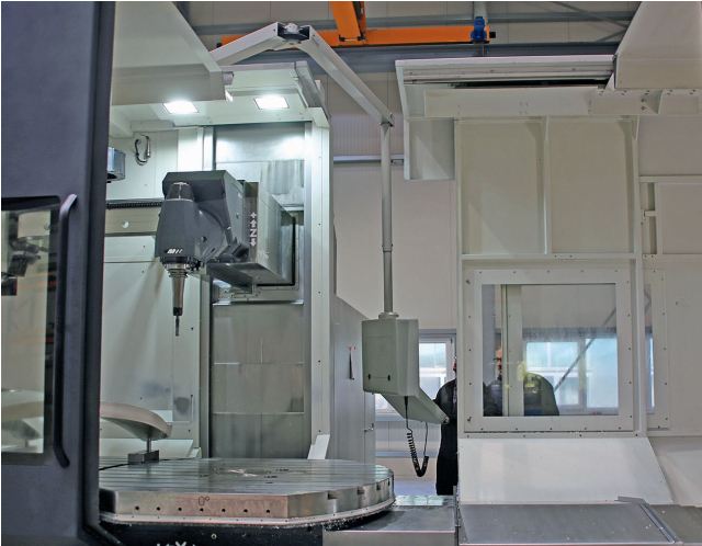
4 Die Bedienkonsole lässt sich bei geöffneter Einhausung durch eine kleine Schiebetür komplett zur Rückseite herüberschwenken. Das ermöglicht eine visuelle Kontrolle der Bearbeitung auch von der Maschinenrückseite her © Klaus Vollrath
