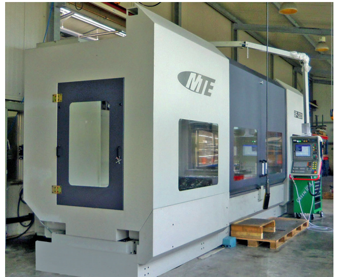
5 Zuverlässiger Dauerläufer: Die 2013 bei der Firma Geilenberg installierte MTE-Bettfräse ‘BF 3200’ läuft seit acht Jahren ohne Probleme © MTE
