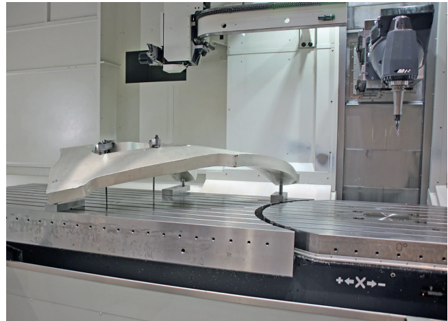
3 Bearbeitung eines geometrisch anspruchsvollen Werkstücks aus Aluminium. Die Gesamtbelastbarkeit beider Tische, fester Spannungsbereich und Drehtisch, liegt bei 13 t © Klaus Vollrath
